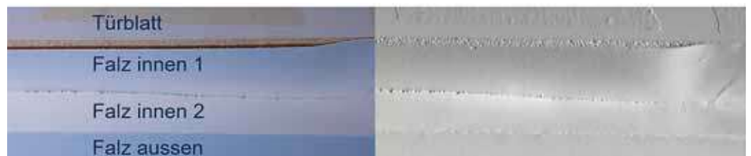
Abb.4: Foto eines Türfalzes, Strukturbild des Scans längs des Türfalzes
