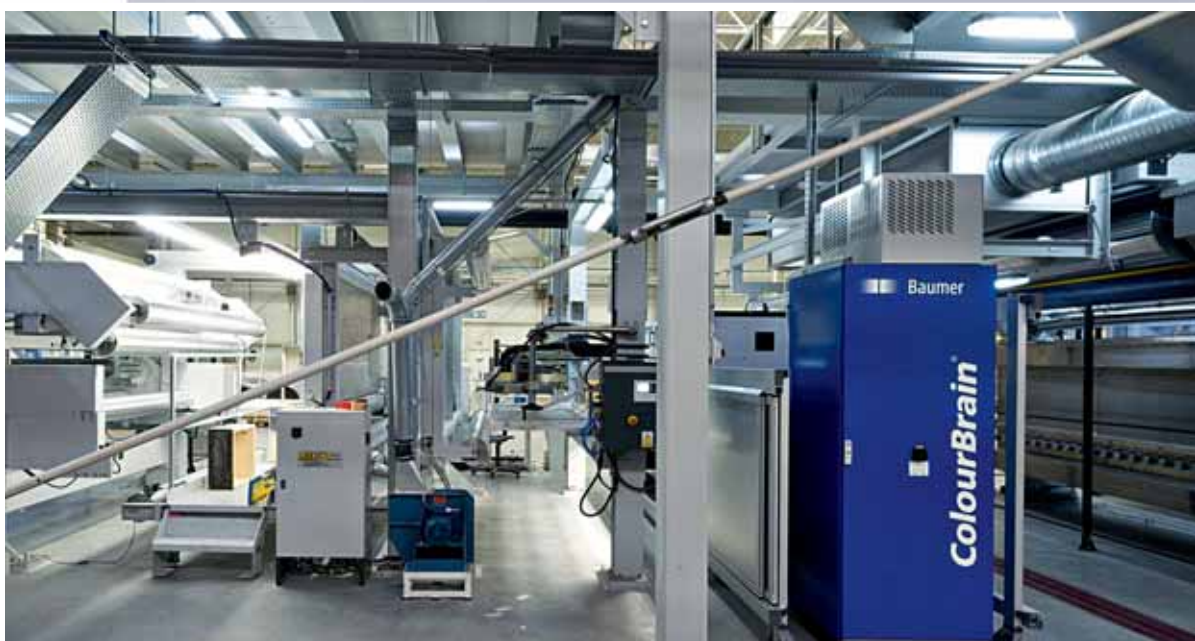
„Color Brain Deco Inspector“ in der Lackierlinie des Dekordruckers
