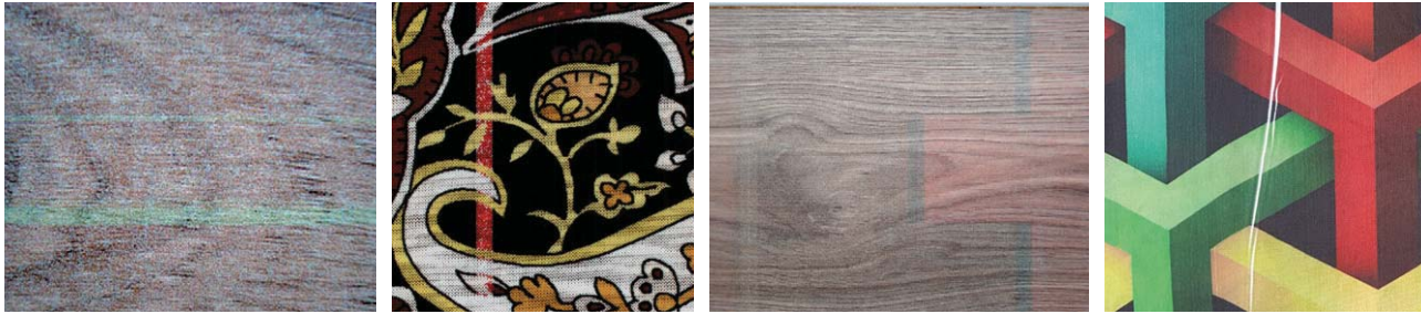
Beispiele von Defektbildern: (obere Reihe v. l.) Ausfall mehrerer Düsen, Ausfall eines Druckkopfsegments, Ausfall einer gesamten Druckkopfleiste, Falte im Substrat; (untere Reihe v. l.) Substratfehler, Synchronisationsfehler, Verschmutzungen, Tintenflecken
