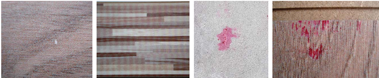
Beispiele von Defektbildern: (obere Reihe v. l.) Ausfall mehrerer Düsen, Ausfall eines Druckkopfsegments, Ausfall einer gesamten Druckkopfleiste, Falte im Substrat; (untere Reihe v. l.) Substratfehler, Synchronisationsfehler, Verschmutzungen, Tintenflecken
